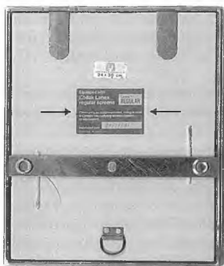
Figura 8.5 Identificação do tipo de écran no chassi
