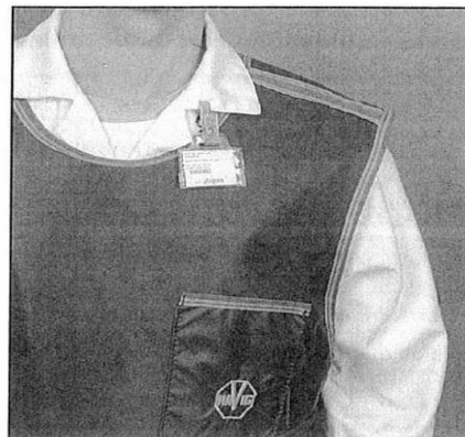
Figura 8.2 Ilustração do posicionamento do dosímetro com o uso de avental plumbífero
